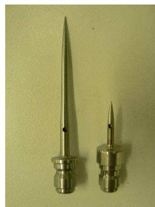
Photos 44 - 45. Pistolet injecteur et aiguilles d'injection à orifice latéral.
