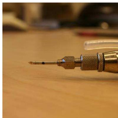
Photos 46 - 47. Seringue d'injection pour bétail remaniée pour l'injection. Aiguille d'injection pour bétail biseautée et percée latéralement pour l'injection.
