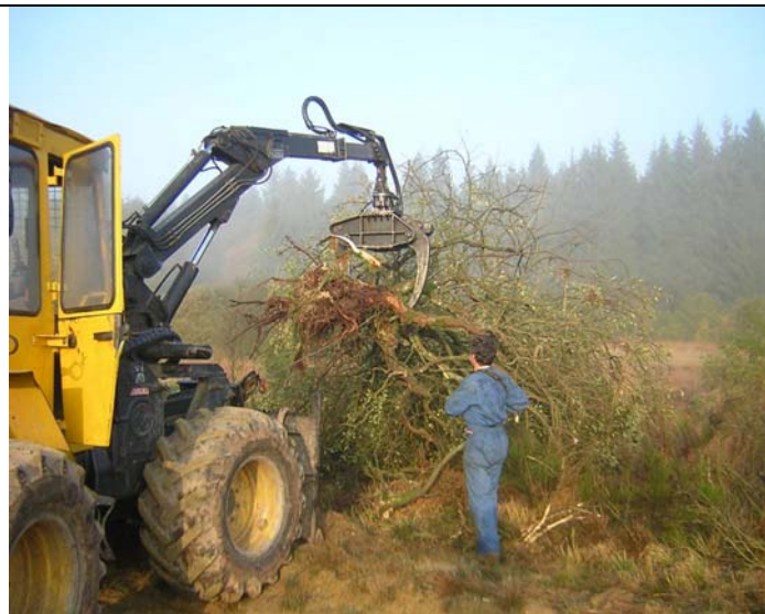
Elsenborn : arrachage de saules par câblage puis bras articulé
